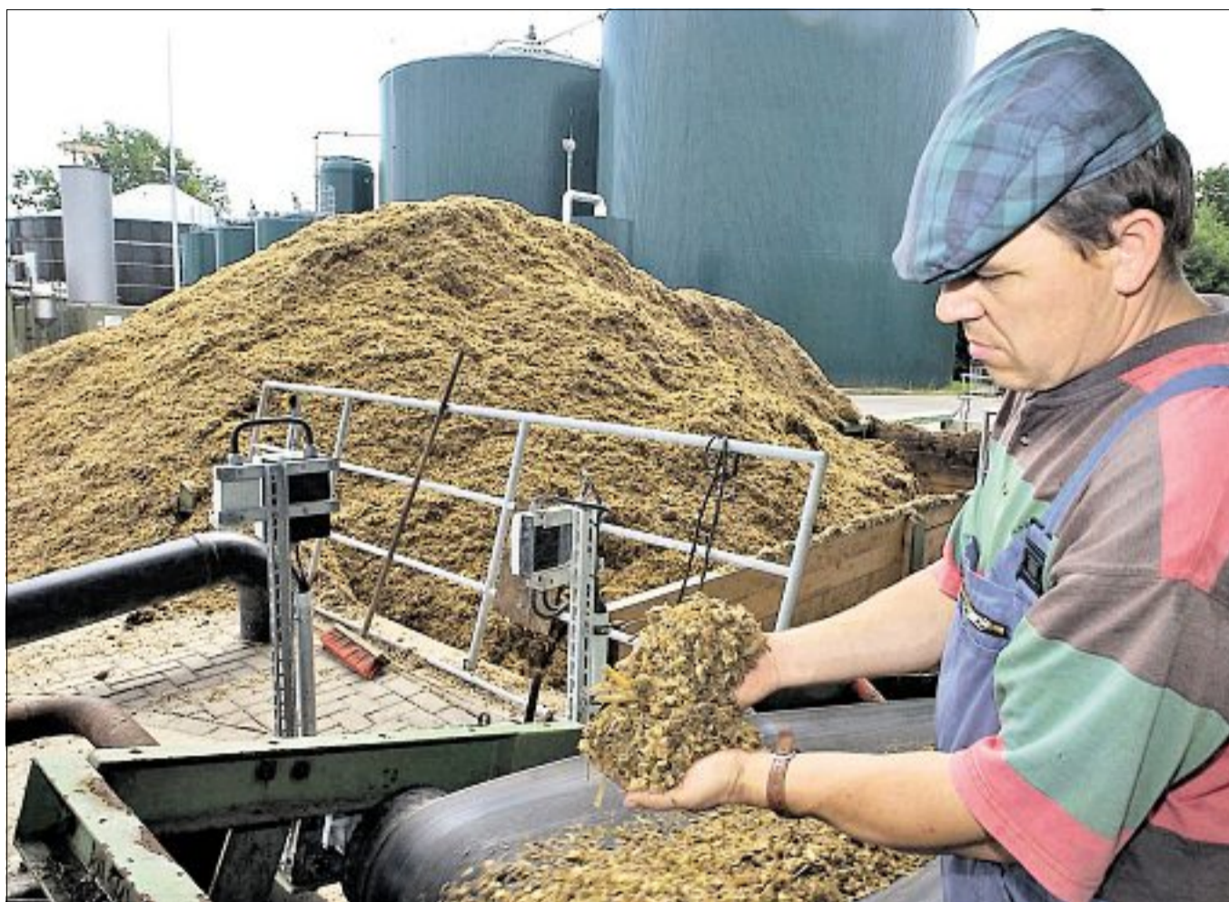
Die Bauern liefern den silierten Mais, aus dem in der Biogasanlage durch Gärung das Biogas entsteht.
